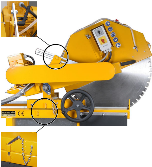
Den Pendelschneidarm in die für Sie vorteilhafte Position schwenken und mit dem Klemmhebel arretieren; Den Schneidwagen mit dem Absteckbolzen sichern Bild 5.10
