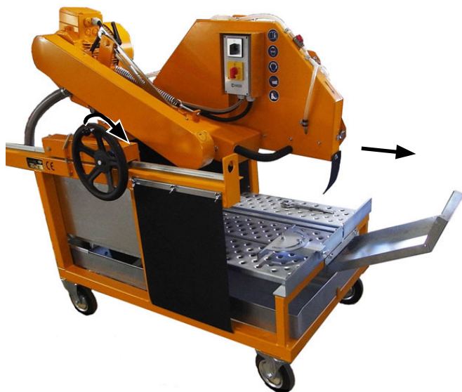
Schneidwagen mit dem Handrad, bis zum Anschlag, nach vorn fahren Bild 4.15
