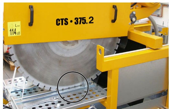
Pendelschneidarm (Trennscheibe) auf die maximale Schnitt-Tiefe eingestellt Bild 4.31
