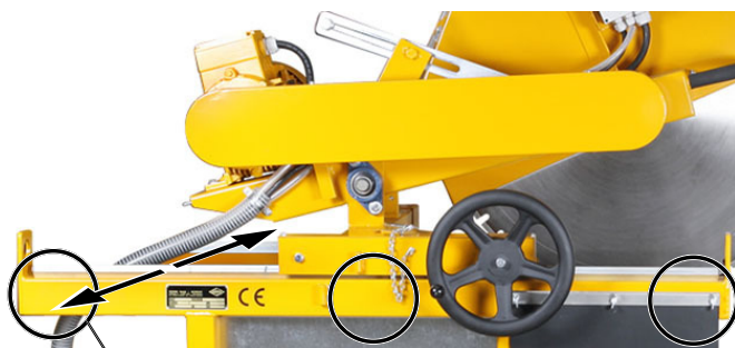
90°-Winkel (Horizontal), fester Anschlag am Auflagetisch zu Trennscheibe prüfen Bild 5.1
