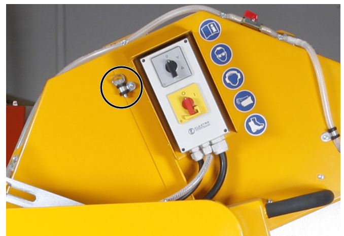
Vierkantschlüssel für die Verriegelungen am (Trennscheiben-) Blattschutz in der Halterung Bild 4.18
