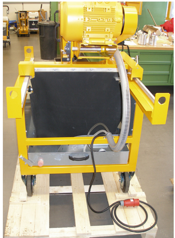
Netz-Anschlusskabel mit CEE-Stecker an der CTS•375.2 Rückseite Bild 4.35
