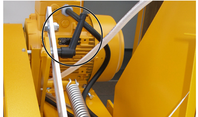
Klemmhebel lösen und den Pendelschneidarm festhalten Bild 4.29
