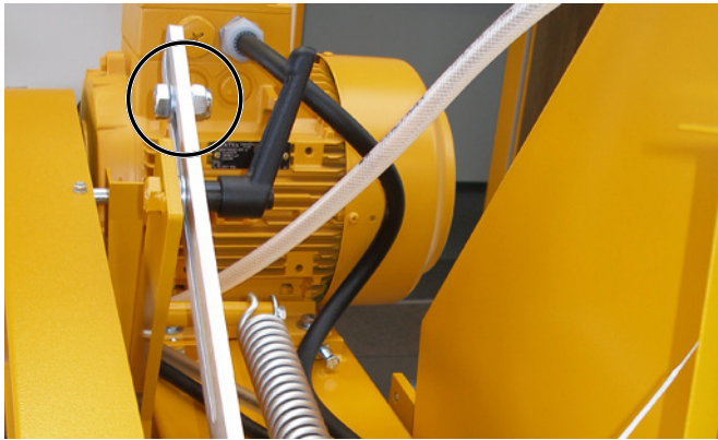
Pendelschneidarm Tiefen-Anschlagschraube montiert Bild 4.32
