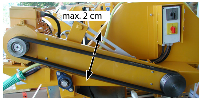
Sechskantschrauben und Unterlegscheiben am Keilriemenschutz Bild 5.11
