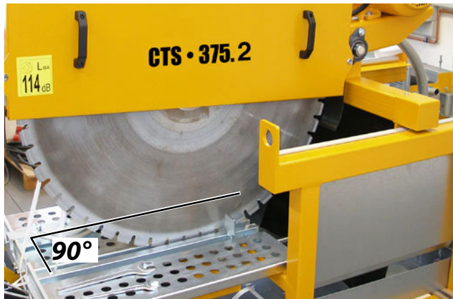
90°-Winkel (Horizontal), fester Anschlag am Auflagetisch zu Trennscheibe prüfen Bild 5.3
