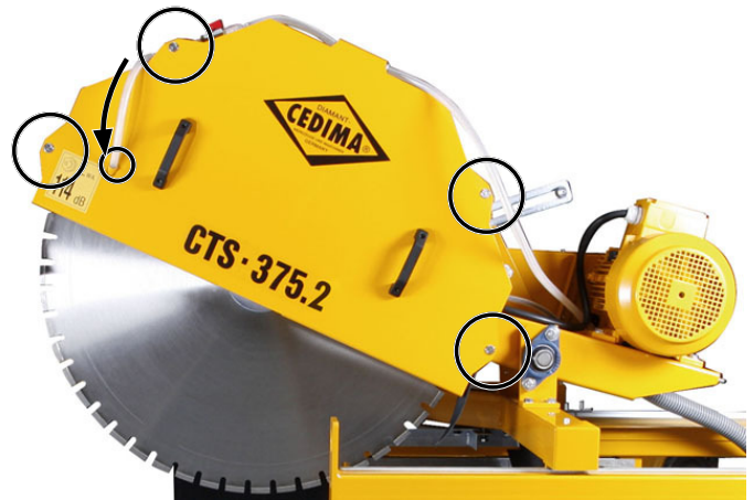
Blattschutz einhängen und mit den Verriegelungen sichern; Den Wasserschlauch in den Blattschutz-Deckel stecken Bild 4.27
