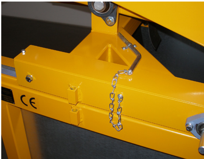
Absteckbolzen in Halterung, Schneidwagen beweglich Bild 4.3
