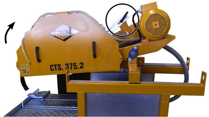
Pendelschneidarm mindestens waagrecht ausheben und mit dem Klemmhebel festklemmen Bild 4.16
