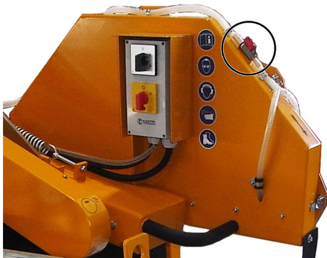
Beidseitiger Wasserzulauf im Trennscheibenschutz, stufenlos mit Absperrhahn regulierbar Bild 4.12
