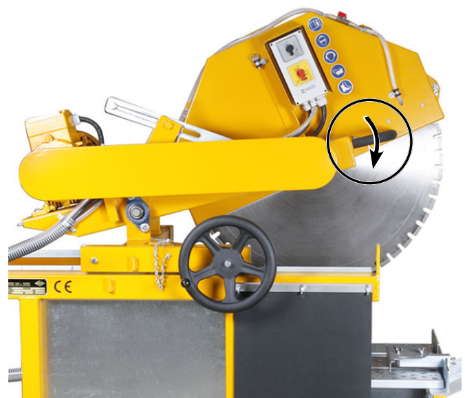
Den Pendelschneidarm mit der Trennscheibe absenken Bild 4.30
